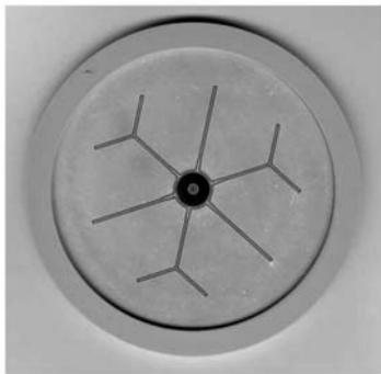
Abb. 3.4.9 Gatestruktur eines lichtzündbaren Thyristors von Infineon. Durchmesser 119mm
