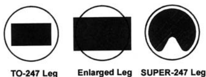
Abb. 4.2.6 Verringerung des Widerstands der Anschlüsse in TO-Gehäusen. Aus [Swa00]
