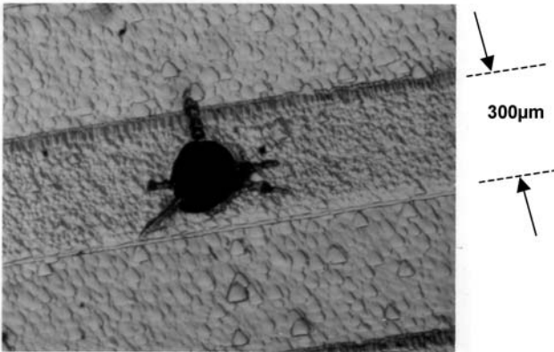
Abb. 5.5.1 Durch Überschreiten des maximal abschaltbaren Stroms ausgefallener GTO-Thyristor. Schmelzkanal, verursacht durch ein Stromfilament in der Mitte eines Kathodenstreifens
