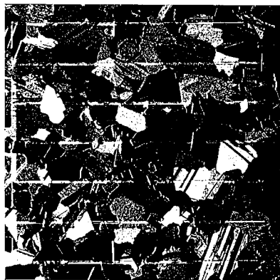
Abb. 6.10: Vergrößerte Aufsicht auf eine mc-SILSO-Solarzelle 2 \times 2 \text{ cm}^2 (multikristallines Silizium: p-leitende Basis, n+-leitender Emitter) mit Vorderseitenkontakt (engl.: gridfinger ). Die kolumnaren Mikrokristallite zeigen ihren Querschnitt. Die Hervorhebung von Bereichen unterschiedlicher kristallographischer Orientierung erfolgte durch anisotropes Ätzen in Kalilauge (KOH).
